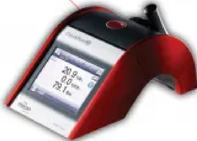
Газоанализатор Dansensor CheckPoint III O2/CO2 Вес: 0,7 кг Объем пробы: 5 л
